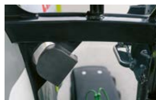
Un paso de cables hacia delante y hacia atrás en la cabina y un carril de montaje en la puerta derecha facilitan la instalación de unidades de mando externas para aparatos acoplados.
