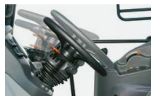
La columna de dirección inclinable y telescópica se deja adaptar a la posición del asiento del conductor.
