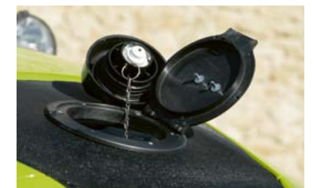
La abertura abatible en alto del capó del motor es muy práctica. Así se puede abrir y rellenar fácilmente el depósito que se encuentra protegido debajo.
