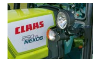
Faros de los intermitentes plegables en NEXOS evitan dañar los cultivos.
