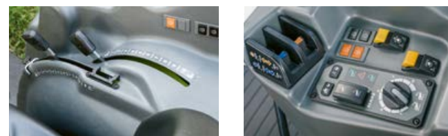
Usted elige entre la regulación mecánica y la electrónica del elevador trasero. Ambas están colocadas muy a mano a la derecha, junto al asiento del conductor.
