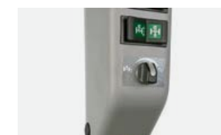
Fácil cambio de los modos para la suspensión del eje delantero en la columna B.
