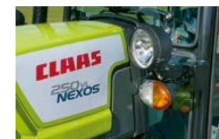
Faros de los intermitentes plegables en NEXOS evitan dañar los cultivos.
