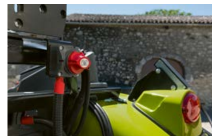
El interruptor de desconexión de la batería se encuentra en la parte trasera de la cabina y ofrece un fácil acceso.
