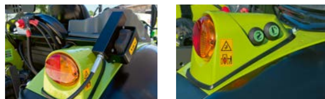
Confortable manejo externo con elevador trasero mecánico o electrónico.
